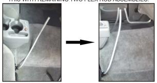
THE MOST STABLE MOUNTING PLATFORM IS ACHIEVED BY MAKING SHARP BENDS AND STRAIGHT PROFILES IN THE FLEX RODS; NOT LONG GRADUAL BENDS AS SHOWN. MAKING USE OF A VICE OR PIPE TO HELP MAKE SHARP BENDS IS RECOMMENDED.
